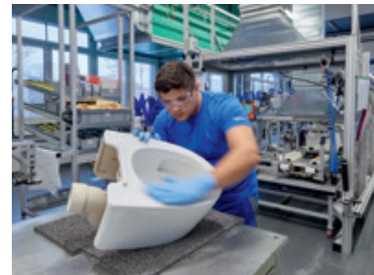
Montering av duschtoaletter...
