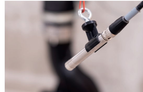
Rumsakustisk mätning av luftljudet från en Geberit Silent-db20 Sovent rördel.
