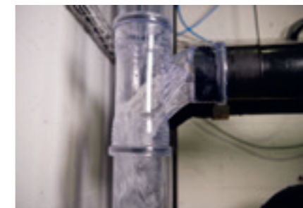
... och det identiska resultatet kan ses under verkliga förhållanden i Geberits avloppstorn, som är en del av testlaboratoriet.
