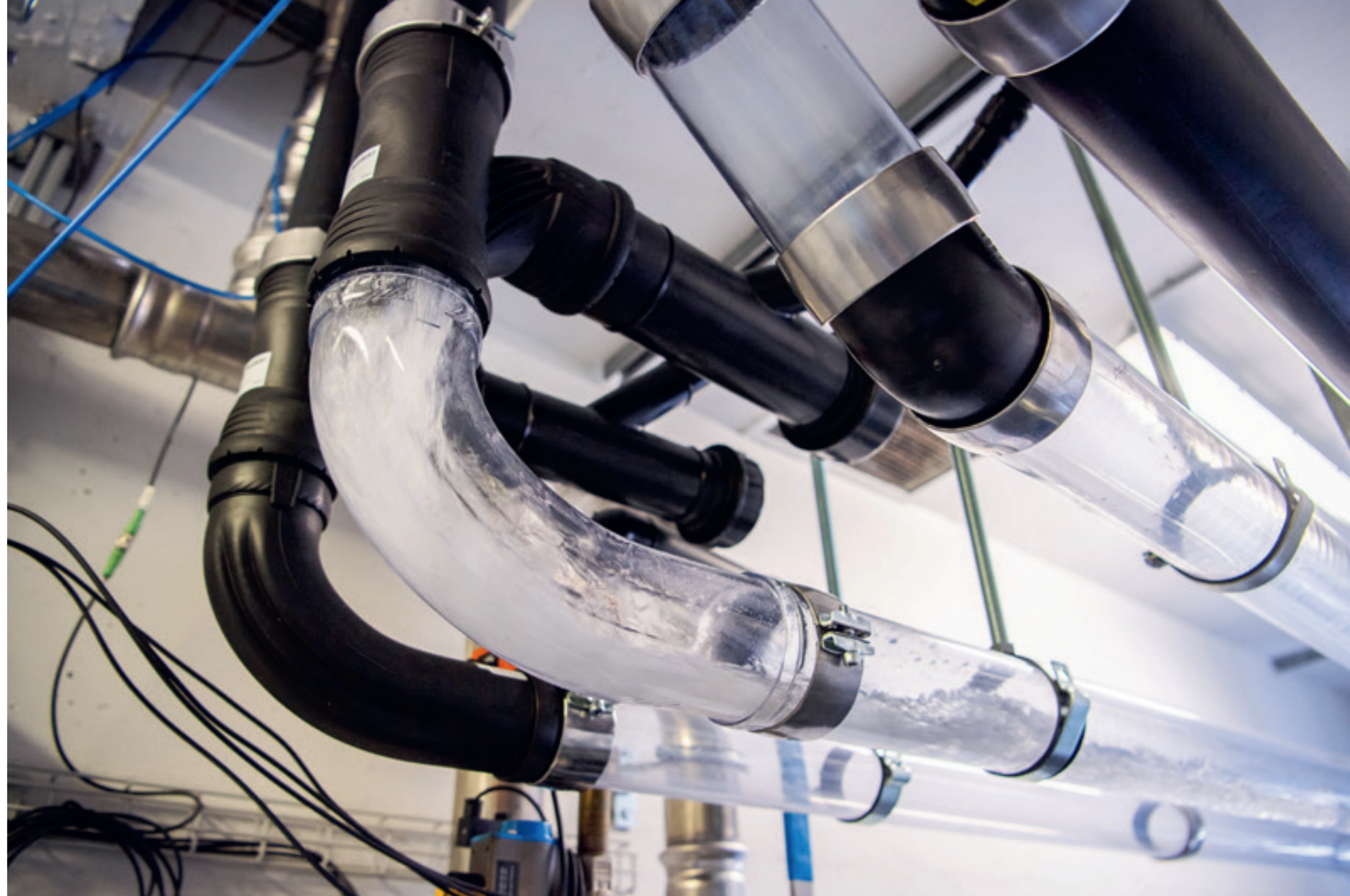
Testet med transparenta delar ger insikter om det verkliga flödet i de nya rördelen.
