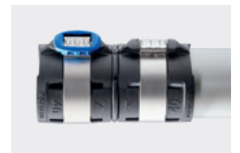
Lätt att identifiera även i mörka hörn: Antingen sitter pressindikatorn fortfarande på kopplingen eller också har den redan pressats.
