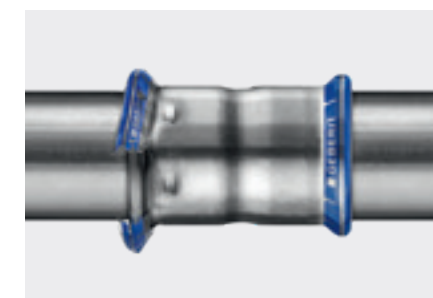
Färgade indikatorer identifierar opressade Mapress-kopplingar även före tryckprovningen.
