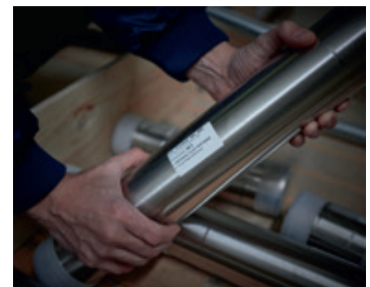
↑ Enkel installation tack vare konsekvent och tydlig märkning av de specifikt kapade rören.
